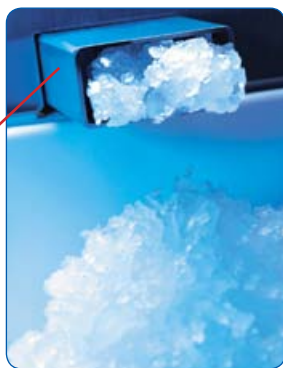
proces tworzenia lodu łuskanego
